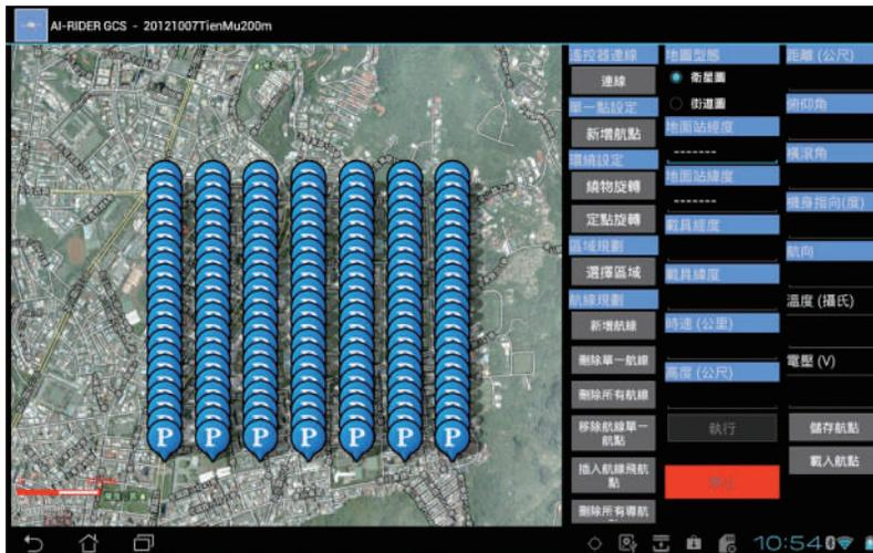
圖8 AI-RIDER YJ-1000-HC多旋翼UAV航線規劃軟體規劃航線圖示
