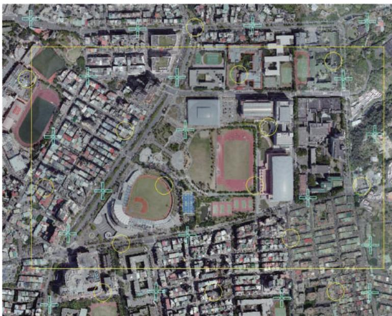
圖7 控制點與檢核點分布圖（藍色十字標為控制點；黃色圓圈O為檢核點）
