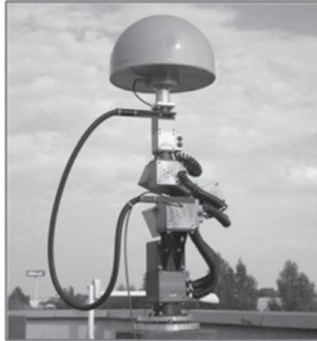
圖5 絕對檢校場天線校正示意圖 (Wübbena, 2000)
