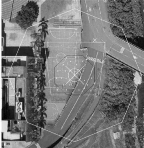
圖5 熱像儀率定場設計說明圖
