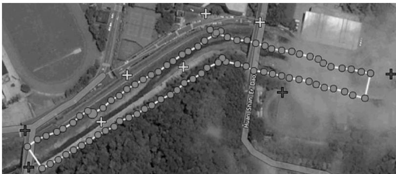
圖11 規劃之航點、控制點（深藍）與檢核點（淡藍）分佈圖
